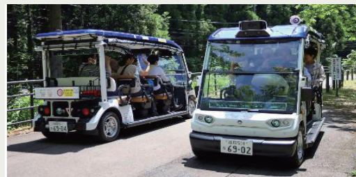
▲永平寺町で運転を始めた自動運転車 全長約2kmの区間を、運転手なしで走ります。
